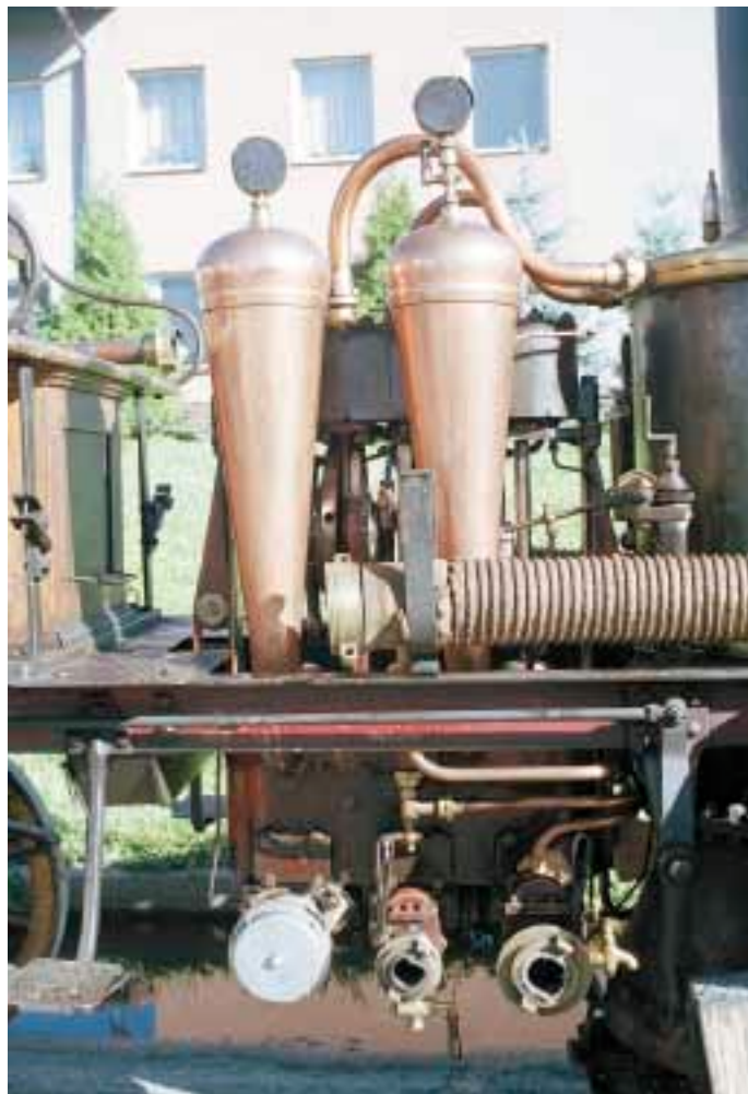
Dva samostatné kuželovité výtlačné větrníky s rozvodnými armaturami a parním poháněcím strojem stříkačky.
