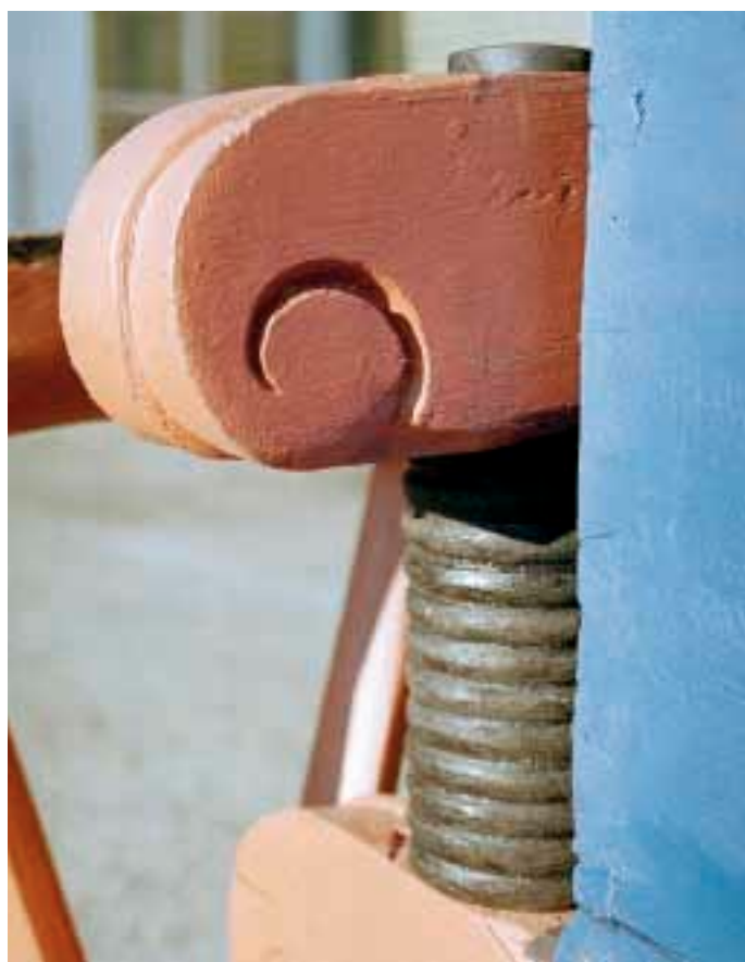
Vzpěra pro zachycení mohutných nosníků vany stříkačky.
