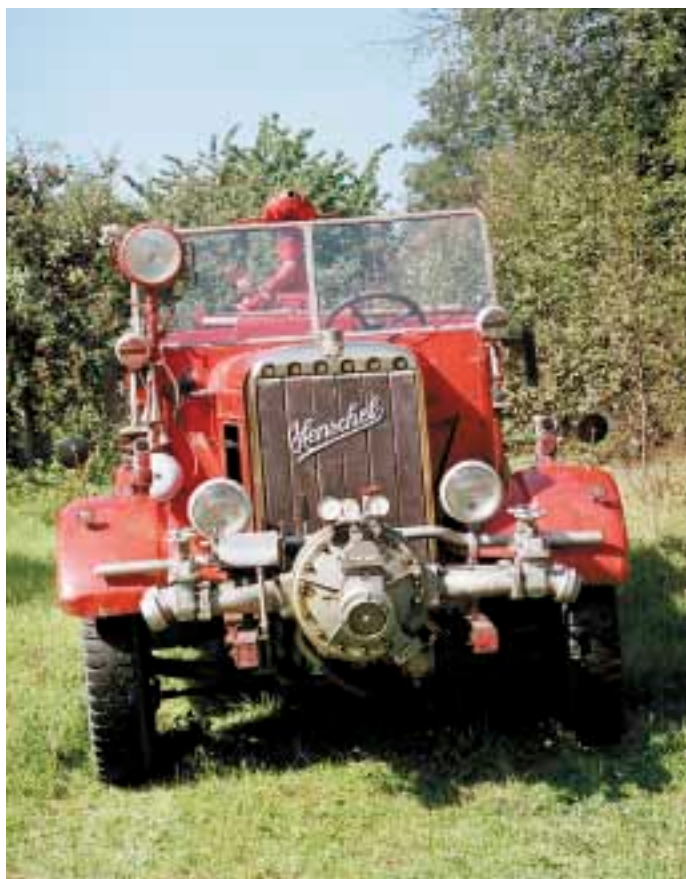
Přední části vozu vévodí mohutné čerpadlo.
