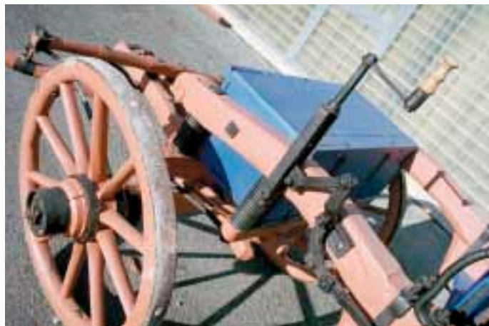
Kolmo uložené otočné páky ruční brzdy.
