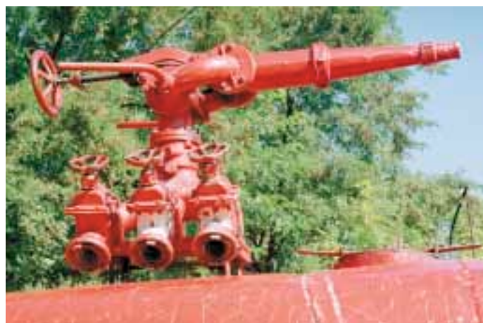
Otočné dělo není z původní výzbroje vozidla (bylo členy sboru vmontováno dodatečně).
