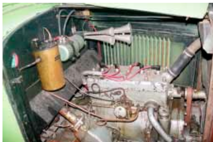
Čtyřválcový motor vozidla s jeho příslušenstvím a melodické pneumatické houkačky.
