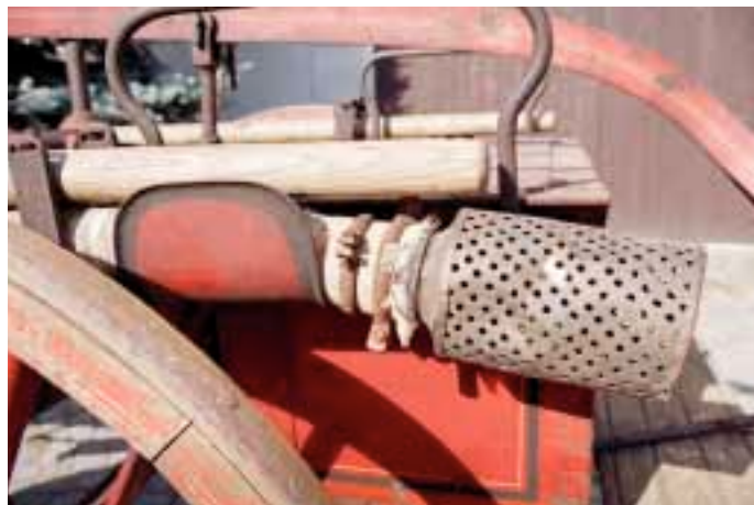
Torzo původního sacího koše připevněného k savici.
