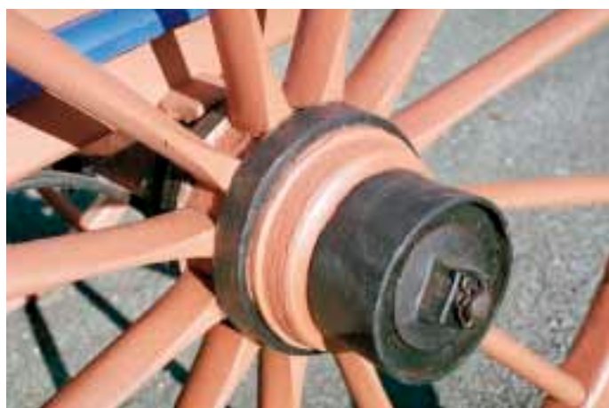
Zajištění kola kovovým kovaným čtyřhranným nábojem se závlačkou.
