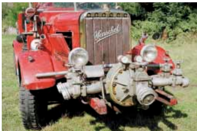
Čelní sání čerpadla a dva, oboustranné výtlaky výkonného vodního čerpadla.
