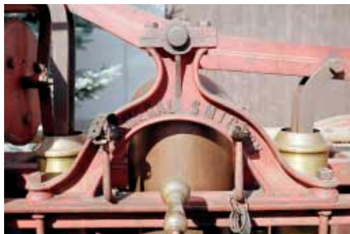
Kozlík stříkačky s pákou a svisle vedenými botami čerpadla.
