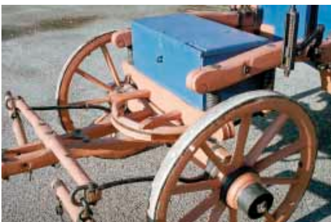
Přední náprava včetně rozporek a části vedení ruční brzdy.
