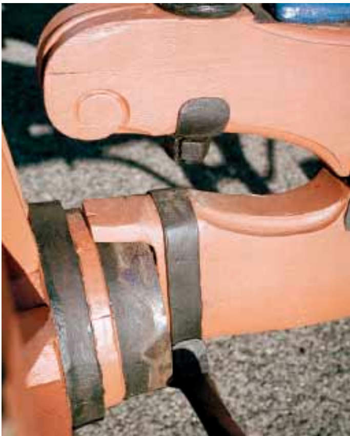
Detail nosníku přední nápravy stříkačky s ochranným páskovým třmenem.
