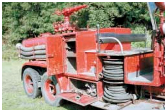
Boční stěny vozidla tvoří skříňky pro uložení hadic a další nezbytné výzbroje.
