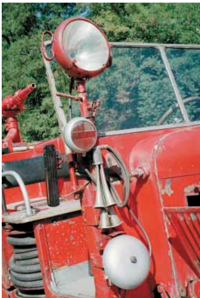
Výstražná zařízení autostříkačky, signální zvonek, pneumatická houkačka, výstražné červené světlo, pákový ukazatel směru a otočný pracovní světlomet.
